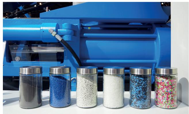
**Bild 8.** Drei unterschiedlich viskose Rezyklate plus dreierlei Additive werden im DCIM-Verfahren in einer Wärme verarbeitet. © Hanser/C. Doriat
